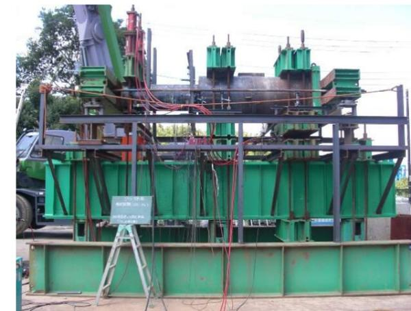
曲げ試験(載荷装置全景)
