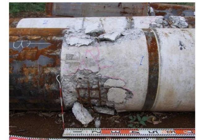
曲げ試験(試験後状況)
