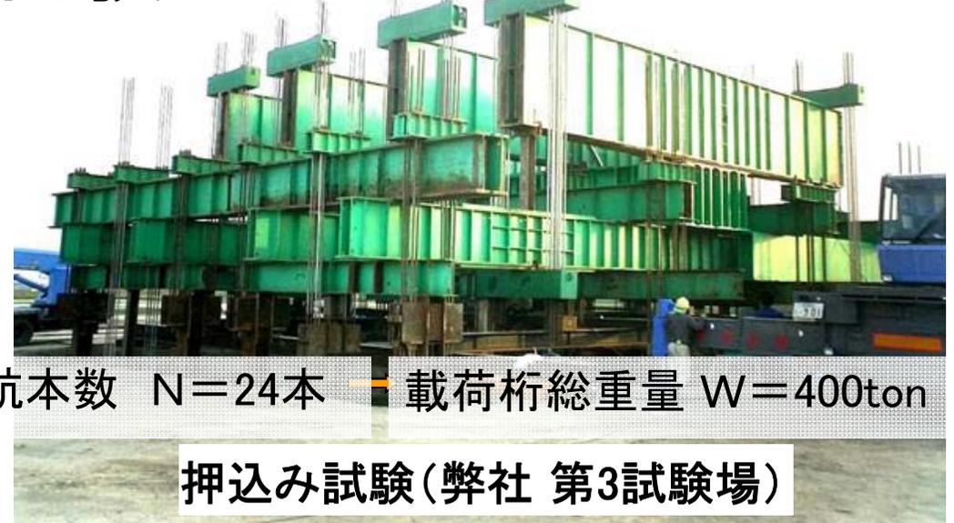
押し込み試験(弊社 第3試験場)
